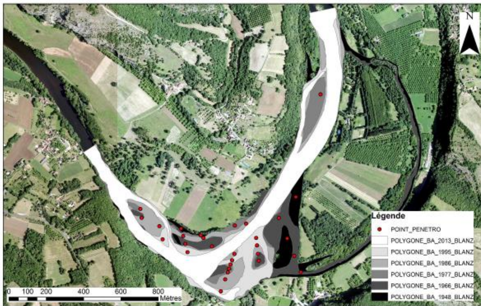
Figure 66. Plan d'échantillonnage des mesures d'épaisseurs de sédiments fins déposés en plaine alluviale récemment construite (1948-2012) sur le tronçon situé entre 72.5 et 76 km à l'aval du barrage du Sablier.
